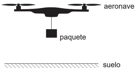
El aire es propulsado verticalmente hacia abajo con rapidez  $v$ . La aeronave se mantiene inmóvil por encima del suelo. Se sujeta un paquete a la aeronave por medio de una cuerda. La masa de la aeronave es de 0,95 kg y la masa combinada del paquete y la cuerda es 0,45 kg. La masa de aire empujada hacia abajo por las palas en un segundo es de 1,7 kg.
