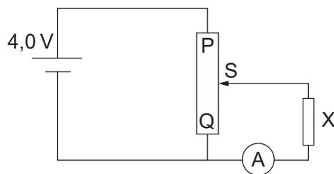
(i) Indique el rango de corriente que puede medir el amperímetro a medida que el cursor S del circuito divisor de potencial se mueve desde Q hasta P.
