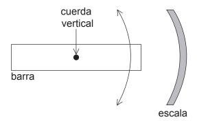
El alumno pone la barra a oscilar y mide el máximo desplazamiento para cada ciclo de la oscilación sobre la escala y el tiempo para el cual se produce. El alumno comienza a tomar mediciones unos pocos segundos después de soltar la barra.
