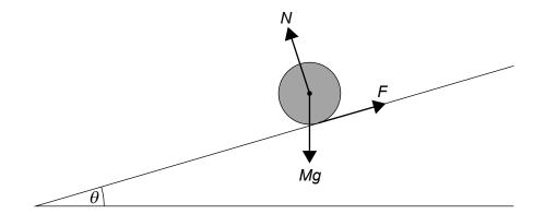
El diagrama muestra las tres fuerzas que actúan sobre el cilindro. N es la fuerza de reacción normal y F es la fuerza de rozamiento entre el cilindro y la pendiente.
