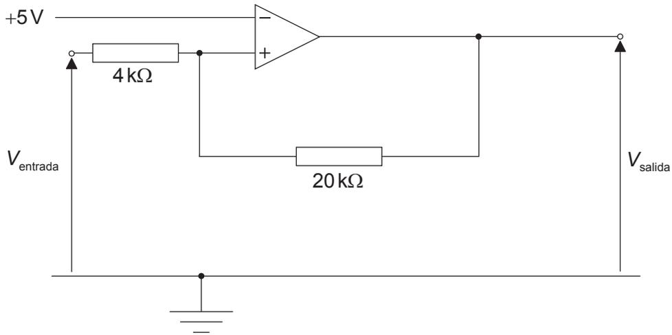
La salida del disparador de Schmitt es de saturación positiva (+15V) o de saturación negativa (-15V). Calcule el valor de entrada que hará que el valor de salida cambie de -15V a +15V.
