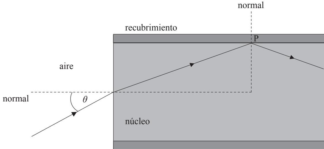
El índice de refracción del núcleo es 1,56 y el del recubrimiento es 1,38.
