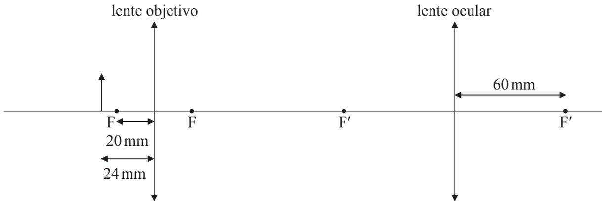
La distancia focal de la lente objetivo es de 20mm y la de la lente ocular es de 60mm. Se coloca un pequeño objeto a una distancia de 24mm de la lente objetivo. El microscopio produce una imagen virtual final del objeto a una distancia de 240mm de la lente ocular.
