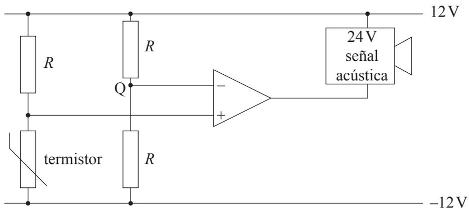
Se requiere que la señal acústica suene cuando la temperatura del termistor exceda los 50°C.
