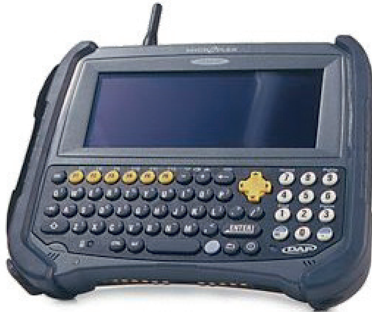
Figura 2: Un terminal móvil de datos de un coche de policía recibe instrucciones de un sistema CAD mediante radio UHF
