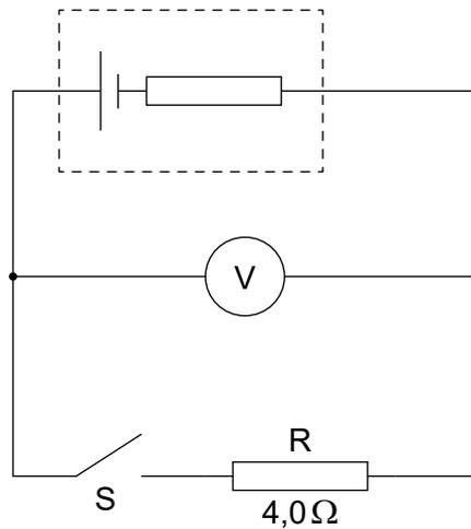
Cuando se abre S, la lectura del voltímetro es de 12V. Cuando se cierra S, el voltímetro marca 8,0V.
