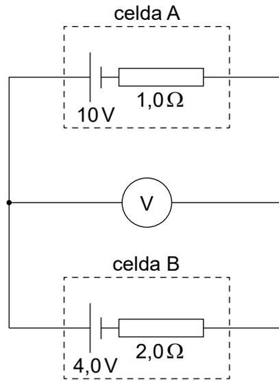
La celda A tiene una f. e. m. de 10V y una resistencia interna de 1,0Ω, mientras que la celda B tiene una f. e. m. de 4,0V y una resistencia interna de 2,0Ω.
